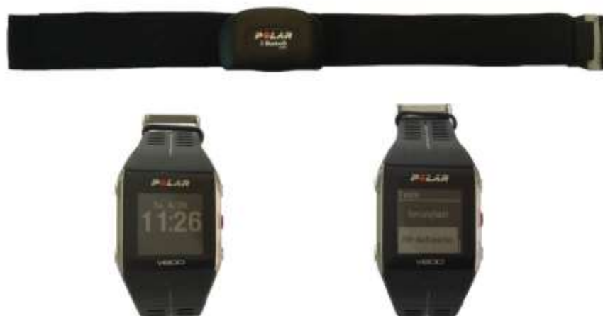
Abbildung 4: Polar H7 Herzfrequenzsensor mit Brustgurt (oben) und Polar V800 Premiumsportuhr (unten) links in Standardfunktion, rechts mit ausgewähltem Modus „RR-Aufzeichnung“
