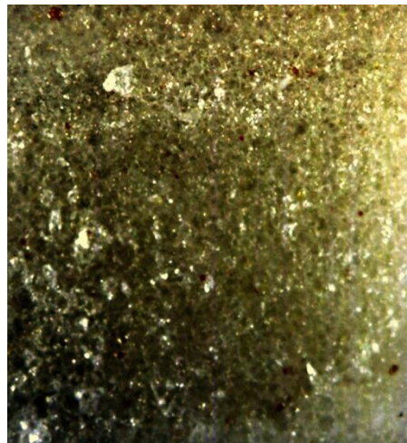
Abbildung 15: Bruchfläche von Snap nach Biegefestigkeitsprüfung
