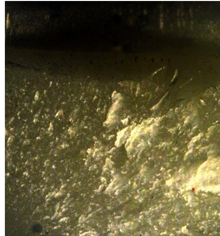
Abbildung 17: Bruchfläche von Protemp 3 Garant nach Biegefestigkeitsprüfung
