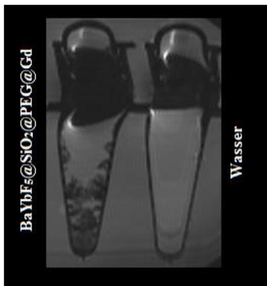
Abbildung 4.35 MRT-Aufnahme (3 T, 123 MHz) der **BaYbF<sub>5</sub>@SiO<sub>2</sub>@PEG@Gd** Partikel.
