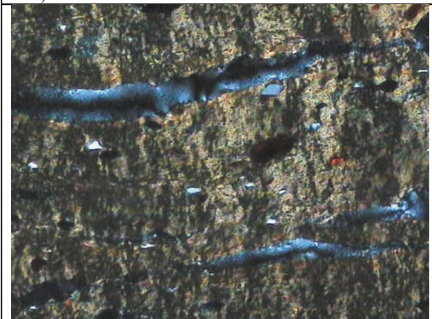
Abb. 12: Probe 4: Doppelbrechende Matrix mit kleinen Quarzeinschlüssen und langen Schwindungsrisse (2 Pol.).
