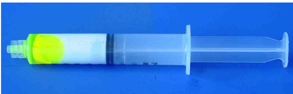
Abbildung 4-16: Spritze von hinten mit Zubereitung befüllt, Raum für Keimsuspension mit Fluorescein-Na-Lösung gefüllt
