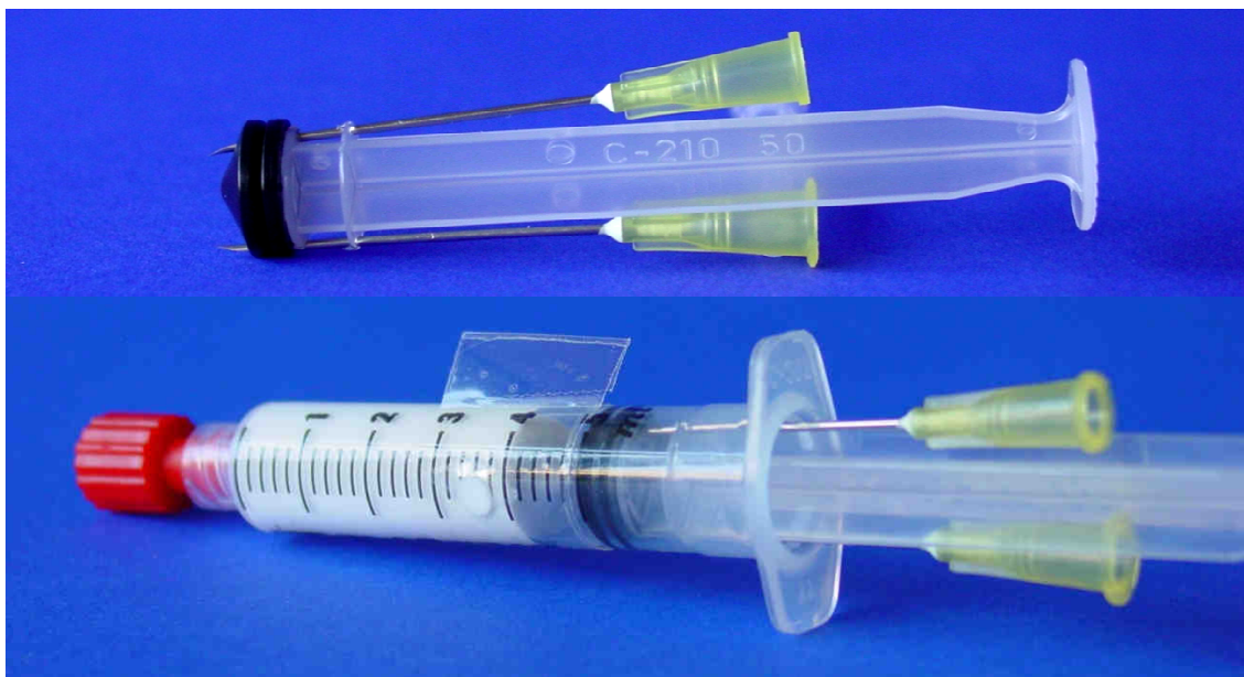
Abbildung 4-19: Spritze mit durchstoßenem Kolben zum Entlüften und Befüllen mit Keimsuspension
