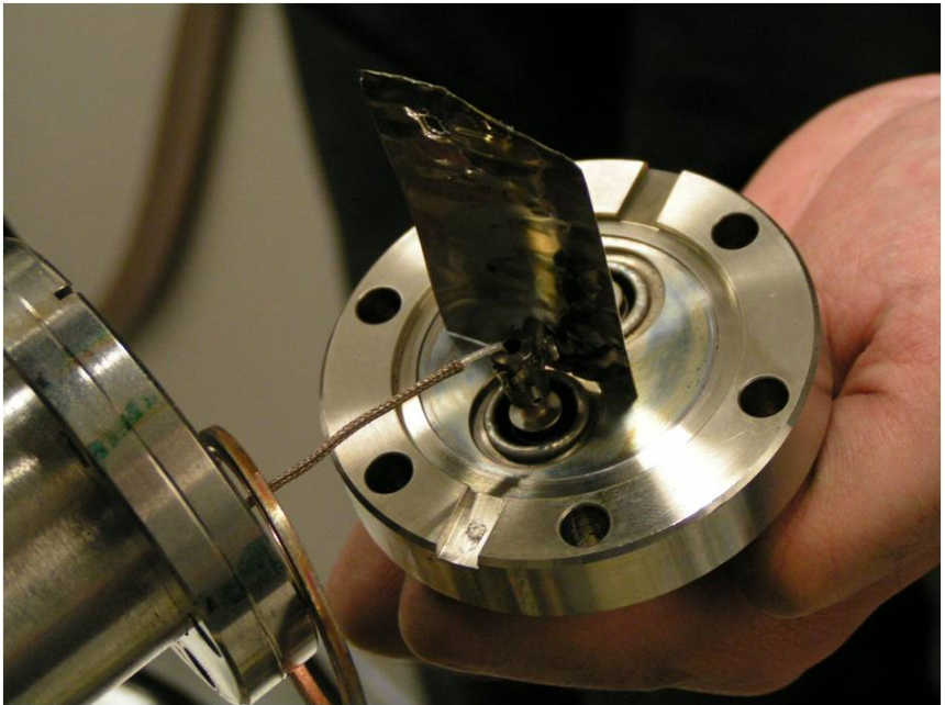
Abb. 25: Elektrische Durchführung an Ultrahochvakuum-Flansch. Die zusätzliche Abschirmung der beiden Kabel mit luftseitigem BNC-Stecker durch ein Blech war noch nicht ausreichend, um das Übersprechen der Spannung für die Piezofolie (vorderes Kabel) auf die Signalleitung (hinteres Kabel) komplett zu verhindern.
