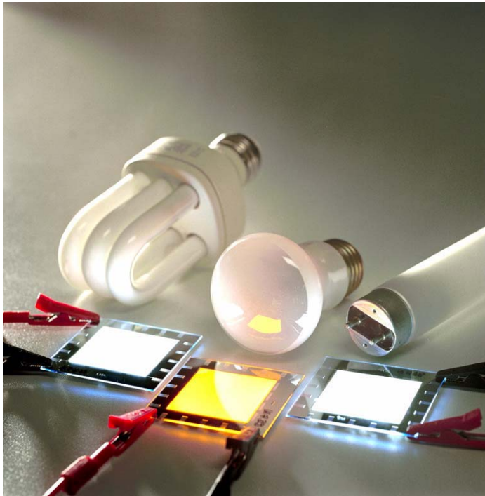
Abb. 2: Prototypen von organischen LEDs zur Beleuchtung neben herkömmlichen Leuchtmitteln. Die hohe Licht-Ausbeute kommt insbesondere dort, wo Wärmeverluste direkt ins Freie abgegeben werden, der Umwelt zugute. (Quelle: Philips)
