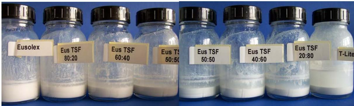
Abbildung 4-23: Fotografische Darstellung der mit Eusolex T-2000 (Eus) und T-Lite SF (TSF) stabilisierten Emulsionen, nach eintägiger Lagerung bei 40 °C
