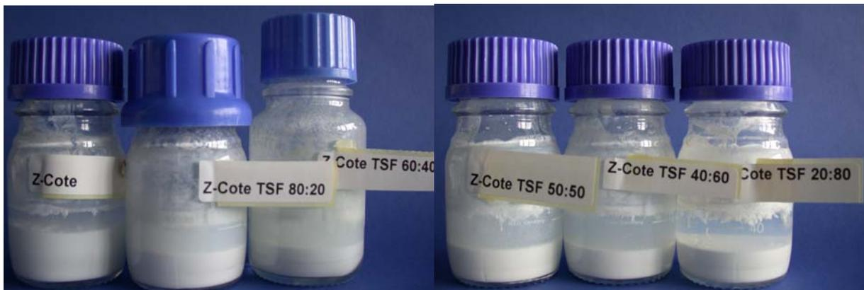
Abbildung 4-31: Fotografische Darstellung der mit Z-Cote und T-Lite SF (TSF) stabilisierten Emulsionen, nach eintägiger isothermer Lagerung
