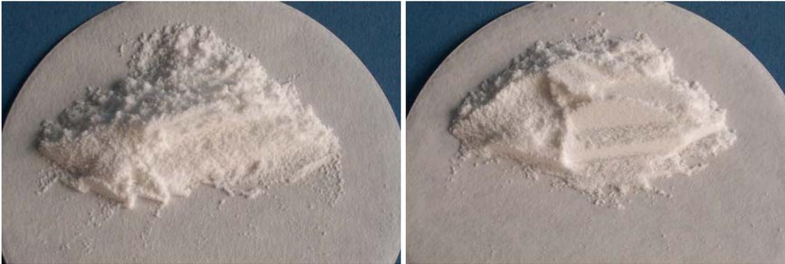
*Abbildung 4-35: Granulat, das unter folgenden Bedingungen hergestellt wurde: Sprühdruk 0,5 bar, Mikroklima 0,2 bar, 400 g Lactose + 100 g Emulsion. Das linke Granulat hat einen Ölgehalt von 12,5 % Öl, das rechte Granulat enthält 20 % Öl*
