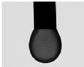
Abbildung 4-22: Darstellung des Tropfens einer wässrigen Suspension mit Eusolex T-2000 in MCT
