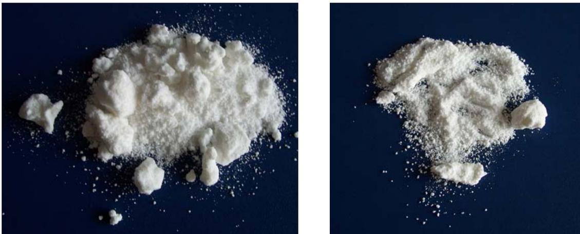
Abbildung 4-34: Granulate die bei unterschiedlichen Bedingungen hergestellt wurden. Linke Abbildung: Sprühdruk 0,6 bar, Mikroklima 0,3 bar, 400 g Lactose + 200 g Emulsion; Rechte Abbildung: Sprühdruk 0,6 bar, Mikroklima 0,3 bar, 400 g Lactose + 100 g Emulsion
