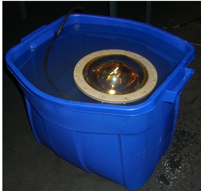
Abbildung 23: Prototyp I in seinem Behälter für den Unterwassertest. Man erkennt die leucht rötliche Färbung des oberen Flansches auf Grund der Schrauben, welche nicht aus Edelstahl waren.
