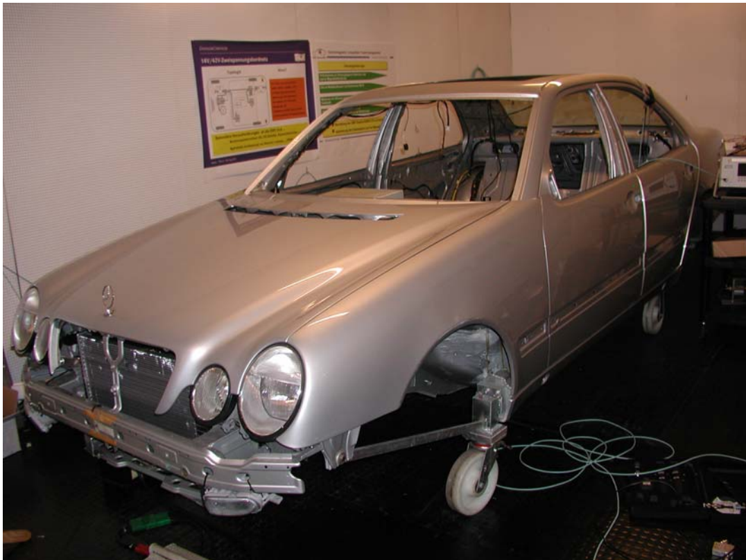
Abb. 7.1: Dieses Bild zeigt eine Fahrzeugkarosse, die sich in einer EMV-Messkabine befindet. Die für den Vergleich mit der Simulation benötigten Leitungen können im Innenraum der Karosse verlegt werden.
