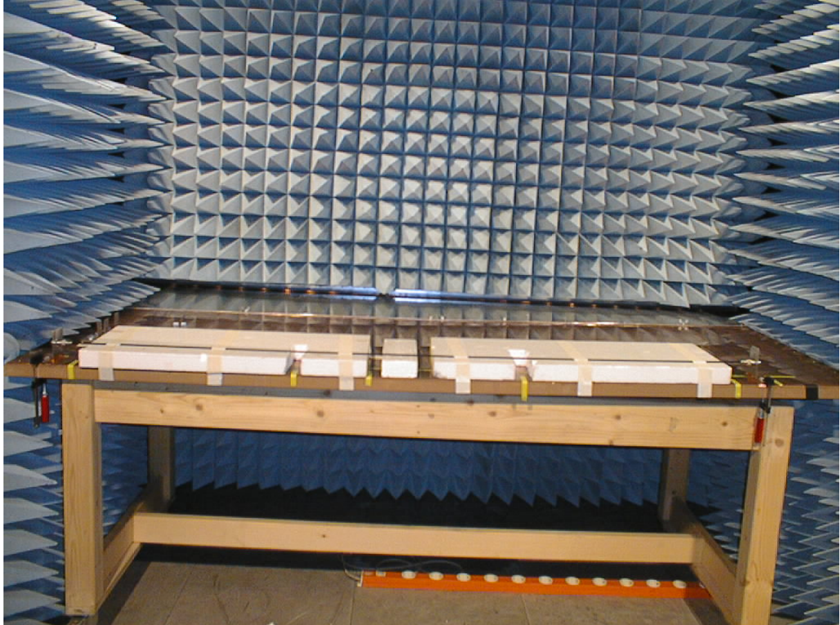
Abb. 6.1: Die Abbildung zeigt den Messtisch mit Kupferplatte, auf dem sich das zu messende RG58-Kabel befindet. Um den Abstand zwischen Leitung und Kupferplatte konstant zu halten, wurden Styroporplatten verwendet. Die Aussparungen entlang der Leitung dienen dem Anbringen der Stromzange. An den Wänden der Messkabine befinden sich sogenannte Absorber, um Reflexionen an den Wänden zu vermeiden.
