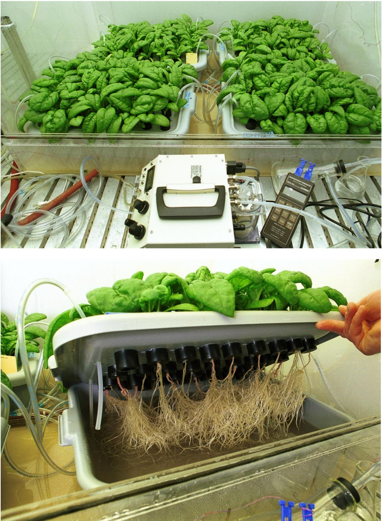
*Abbildung 33: Design der Gewächskammer zum kontrollierten Anbau von partiell deuteriertem Spinat (oben), sowie Wurzeln und Blätter der in Deuteriumoxid angebauten Spinatpflanzen (unten)*
