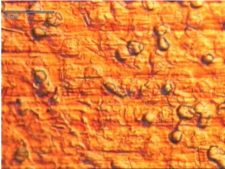
Abbildung 29. Lichtmikroskopische Aufnahme von PMN Granulozyten auf einer Edelstahloberfläche. Die PMN-Granulozyten wurden aus Citratblut durch eine Ficoll-Dichteaufftrennung isoliert und in RPMI-Medium aufgenommen. Das Edelstahlplättchen wurde für 30 Minuten bei 37 °C der Zellkulturlösung ausgesetzt. Anschließend wurden nicht adhärenente Zellen mit RPMI-Medium gewaschen und das Präparat bei 600 facher Vergrößerung unter dem Lichtmikroskop aufgenommen.
