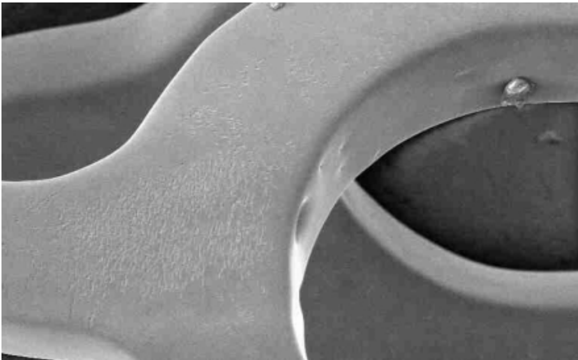
Abbildung 14. DLC-beschichteter Stent, 250-fache Vergrößerung. Ein elektropolierter Stent wurde mit einer 30 nm starken DLC-Schicht versehen und mit einem Rasterelektronenmikroskop bei 250-facher Vergrößerung aufgenommen. Im Vergleich zum unbeschichteten Stent der Abbildung 13 sind keine Unebenheiten auf der Metalloberfläche mehr zu erkennen.
