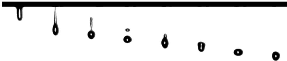
*Abb. 27 Stroboskop-Bilder sich ablösender Tropfen, aufgenommen mit verschiedenen Delayzeiten (Zeitverschiebung zwischen Tropfepuls und Blitz).*
