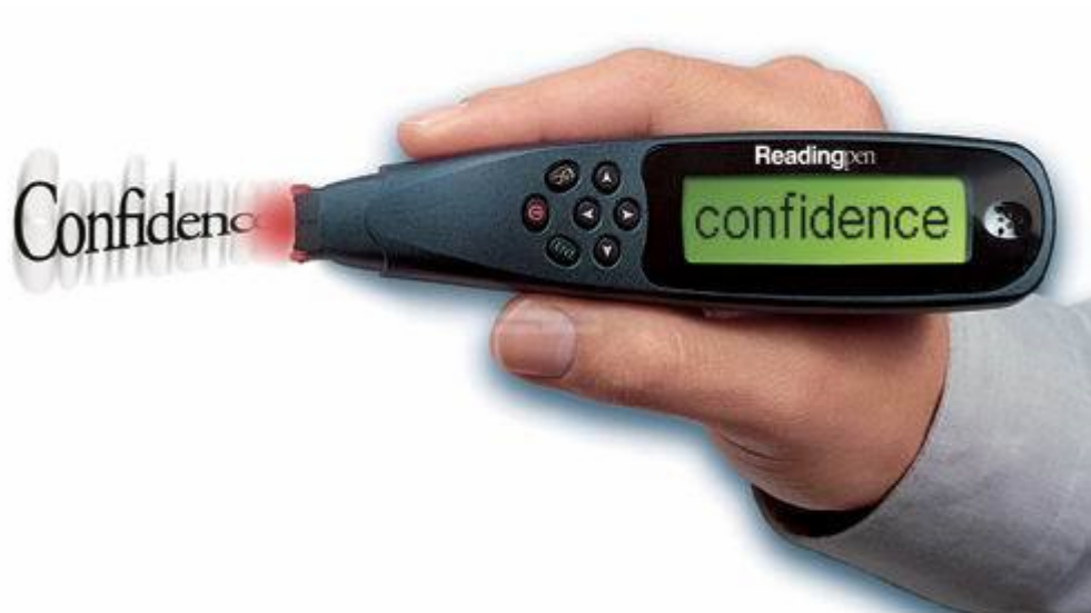
Abbildung 17: Ein Scannstift zum elektronisch unterstützen Erschließen von Schrift.
