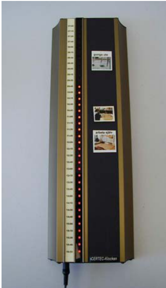
Abbildung 15: Certec-24-Stunden Uhr. Jeder Punkt zeigt eine Stunde. Über das Verhältnis Punkte/Tageszeit kann auch ohne das Lesen der Uhrzeit der Verlauf des Tages abgeschätzt werden. Die Bilder zeigen Tätigkeiten, Ereignisse oder Aufgaben an, die zu dieser Zeit zu erledigen sind.
