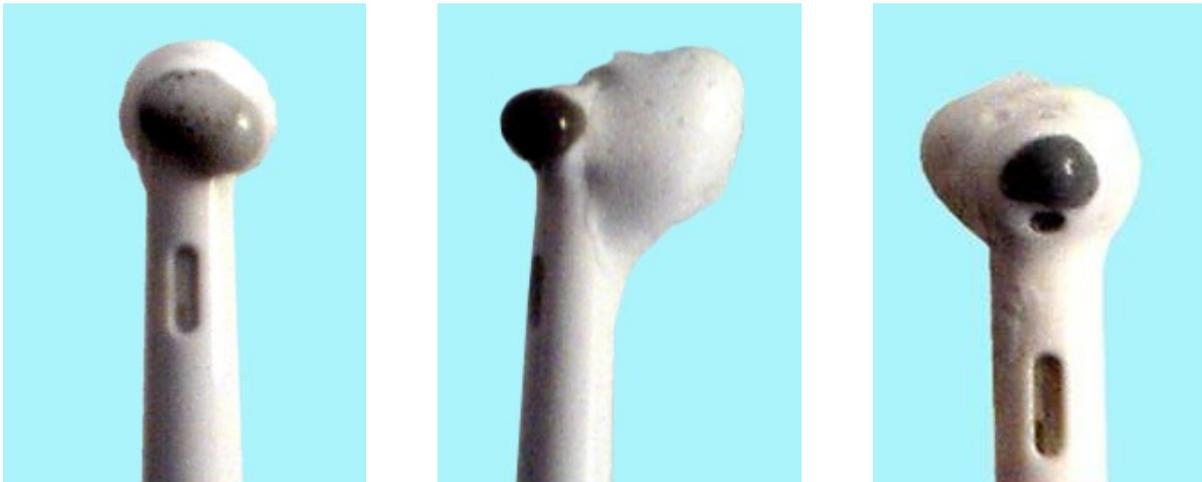
*Abb. 20: Bürstenkopfrückseite mit Austritt
