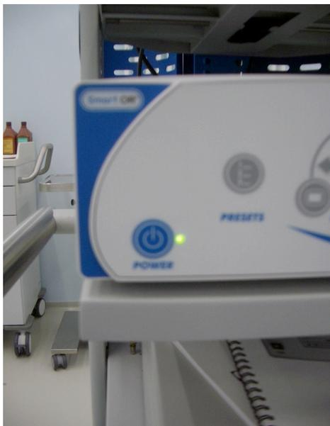
Abb. 136: Off-Zustands-Anzeige der Kamera
