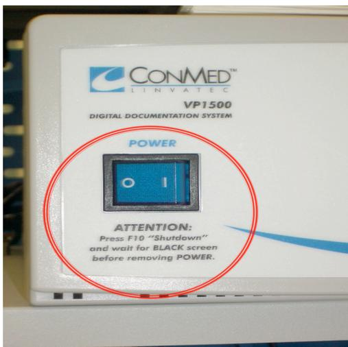
**Abb. 139: Warnung über möglichen Datenverlust bei nicht korrektem Ausschalten**
