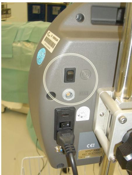
**Abb. 134: Handstückbedientaste an der Rückseite des Shavers ohne Beschriftung**
