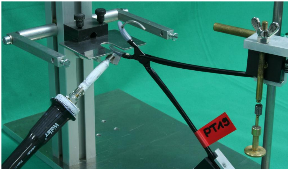
Abb. 13: Versuchsaufbau: eingespannte Klemme Prototyp 19 mit Heizelement an der unteren Branche und Feder zur Einstellung der konstanten Anpresskraft am Instrumentengriff
