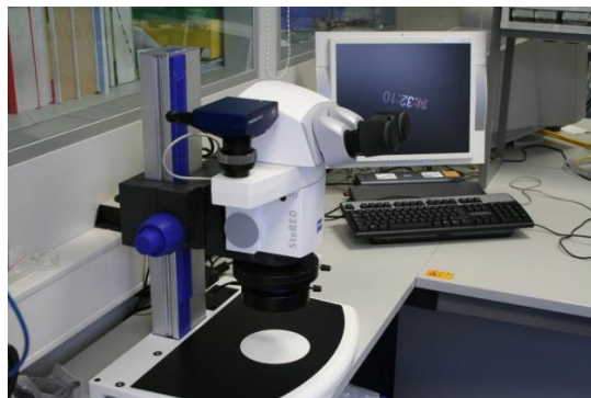
Abb. 15: Lichtmikroskop zur Ausmessung der Koagulationsfläche (vgl. Abb. 12)
