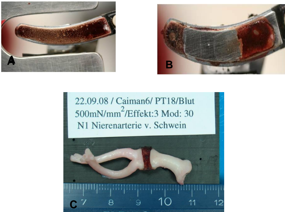
Abb. 8: Fotos der unteren Branche mit einer Kontaminationsschicht aus Schweineblut vor der Koagulation A) und nach der Koagulation B) einer Nierenarterie; koagulierte Nierenarterie mit makroskopisch sichtbarer Blutkontamination im Bereich der Koagulationsfläche C)
