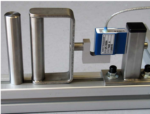
Abbildung 5: Dynamometerkonstruktion für die linke Hand
