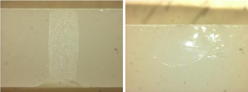
**Abbildung 10.1:** Chippingdefekt am Biegestäbchen Lava (20-fache Vergrößerung). Ansicht von oben und von der Seite
