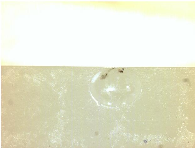
**Abbildung 10.6:** Unregelmäßigkeit an der Oberfläche eines Biegestäbchens in Form von einer Blase (20-fache Vergrößerung)
