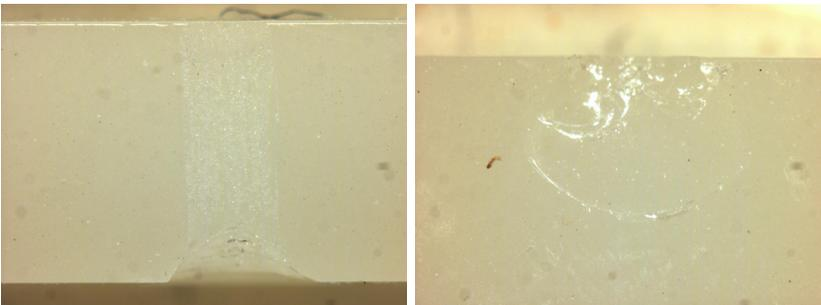
**Abbildung 10.2:** Chippingdefekt am Biegestäbchen Lava (20-fache Vergrößerung). Ansicht von oben und von der Seite
