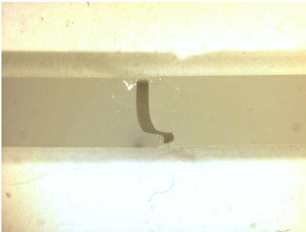
**Abbildung 10.4:** Typischer Bruchverlauf im Biegestäbchen nach erfolgreichem 4-Punkt-Biegetest (6,3-fache Vergrößerung)
