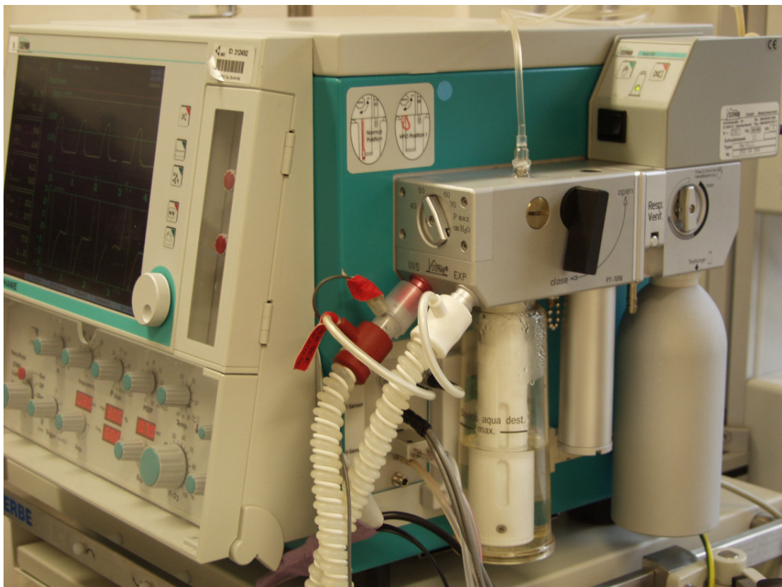
Abb. 5: Beatmungsgerät mit Wasserbad und angeschlossenen Schlauchsystem
