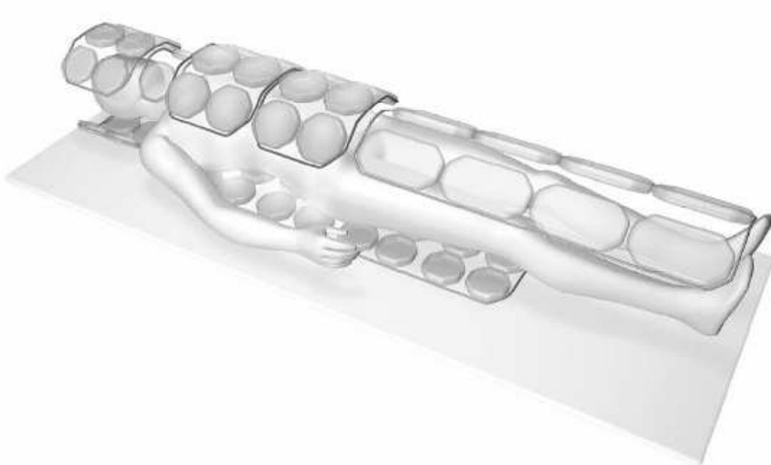
**Abbildung 14. Schematische Anordnung der einzelnen Spulenelemente (Quelle: Siemens Medical Systems, Erlangen)**
