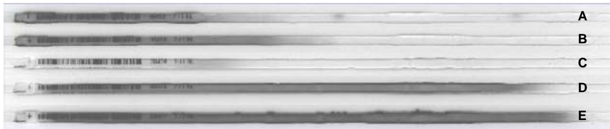
Abb. 5: Probe auf Vorhandensein des jeweils verwendeten Reduktionsmittels im IPG-Streifen pH 7 - 11 ohne Proteinbeladung nach Beendigung der IEF (Tab. 5). Der Nachweis erfolgte anhand der Gelbfärbung nach 3 min Inkubation in 20 mM Tris-HCl Puffer pH 8,0 mit 1 mM DTNB (Ellmanns Reagenz) - Verwendung von 65 mM DTT (A), 130 mM DTT (B), 5 mM TBP (C) und 5 mM TCP (D) bzw. 10 mM TCP (E). Eine deutliche und flächendeckende Reaktion mit DTNB ist ausschließlich bei Verwendung von TCP (D, E) zu verzeichnen.
