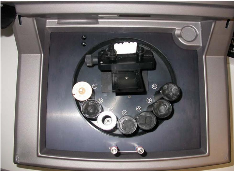
**Abbildung 7** Eingespanntes Gipsmodell in Laserscan-3D
