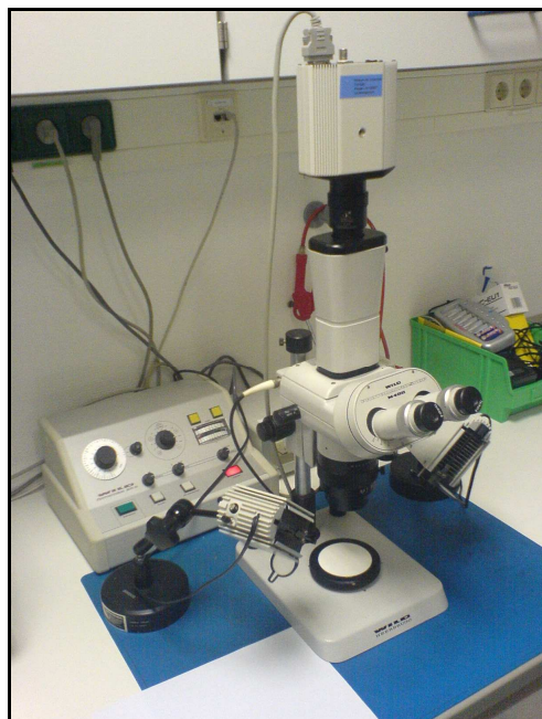
Abbildung 20: Photomakroskop Typ M400 (Wild/Heerbrugg)
