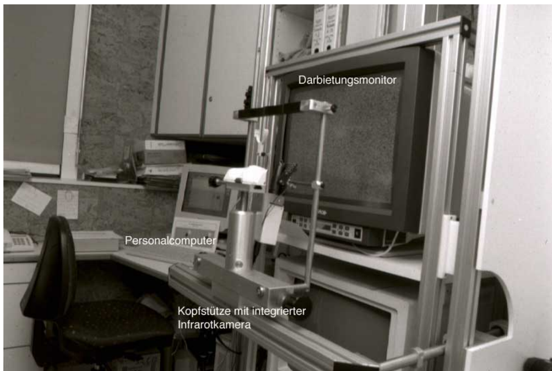
Abbildung 7: Das Tübinger Computer Campimeter besteht aus einem Power Macintosh, einem BARCO Echtfarbenmonitor, auf dem die Stimuli präsentiert werden, einer Kopf- und Kinnstütze (mit integrierter Infrarotkamera) und einem IBM-kompatiblen PC mit Bildschirm zur Pupillen- und Fixationsüberwachung.
