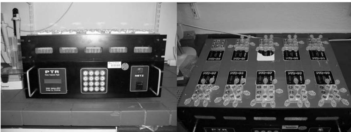
*Foto.1: PTR-Gerät: Jeder einzelne Stahlblock konnte separat von den anderen gekühlt und beheizt werden.*
