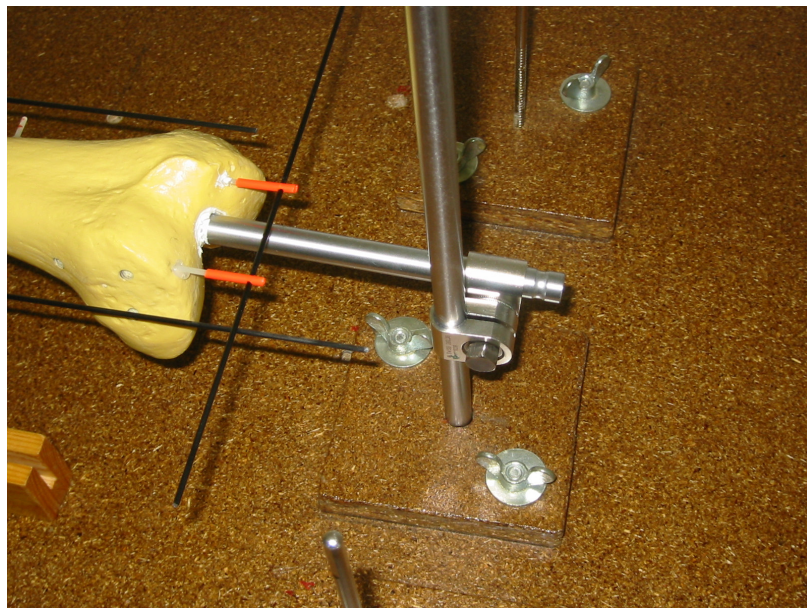
Abbildung 24: Jede gewünschte Position konnte mit Schrauben auf den Metallrohren fixiert werden.
