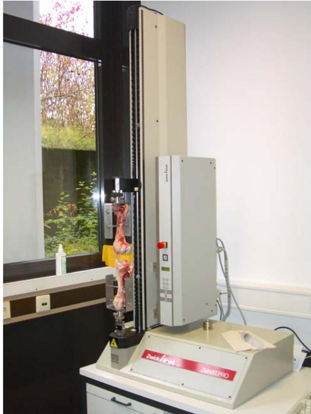
**Abbildung 13:** Materialtestungsmaschine
