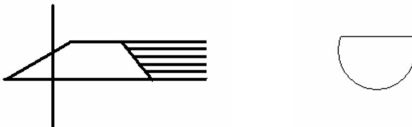
**Abbildung 24:** In dieser Arbeit verwendete Knochenblockform; die Linie gibt die Stelle an, die einen Querschnitt besitzt, wie er im rechten Teil der Abbildung dargestellt ist.
