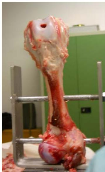
**Abbildung 11:** Femur in der Metallbügelhalterung
