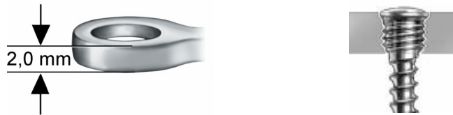
Abbildung 21: Maßseinheit und Winkelstabilität
