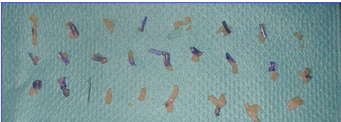
Abbildung 23: fragmentiertes Gel-Modell (Durchmesser 14 mm), vakuumbiopsiert mit einer 8 G-Nadel, Anzahl der entnommenen Zylinder: 25, 19 Zylinder enthalten das Gel-Modell (Quelle: Dr. U. Krainick-Strobel, I. Majer).
