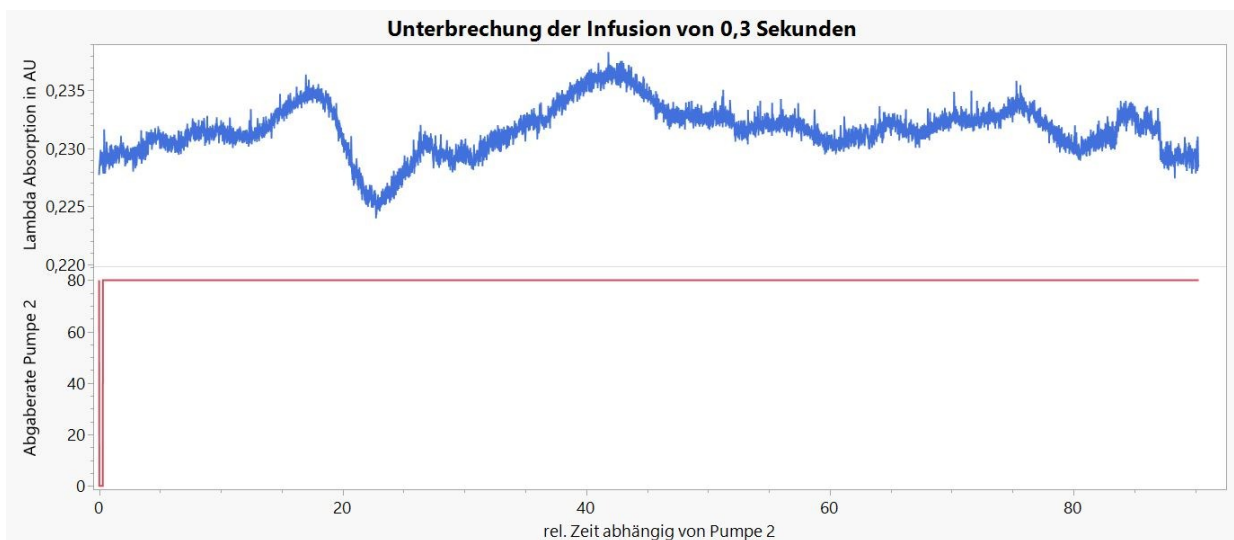
Abbildung 21: Unterbrechung der Infusion von 0,3 Sekunden: Dargestellt sind die gemessenen Absorption in AU und die Abgaberate der Pumpe 2
