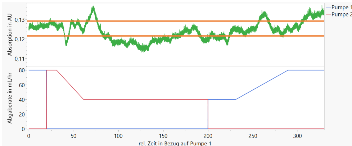
Abbildung 59: Darstellung Unterschiedlicher Asymptoten je nach Ansatz. Hierbei handelt es sich um den selben Versuch wie in Abbildung 54. Es handelt sich um einen linearen Übergang mit Start Pumpe 1 nach 31 Sekunden und Dauer 58 Sekunden, Pumpe 2 startet nach 11 Sekunden und mit einer Dauer von 30 Sekunden. Zu sehen ist eine Überlagerung der drei Durchgänge aufgenommen bei 630nm und 10mmHg.
