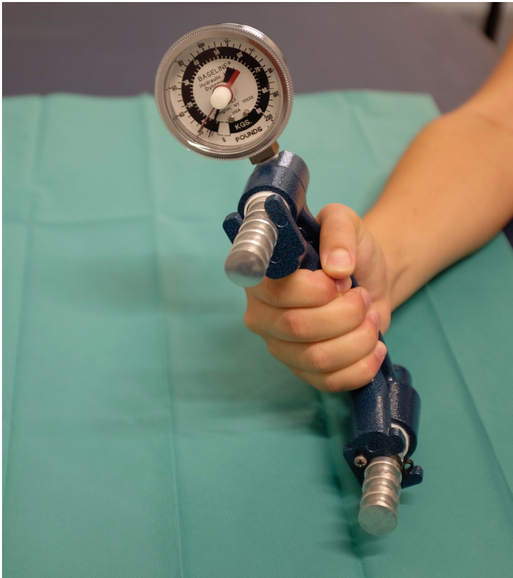
Abbildung 12 Messung der Grobgriffkraft mittels Hydraulic Handdynamometer
