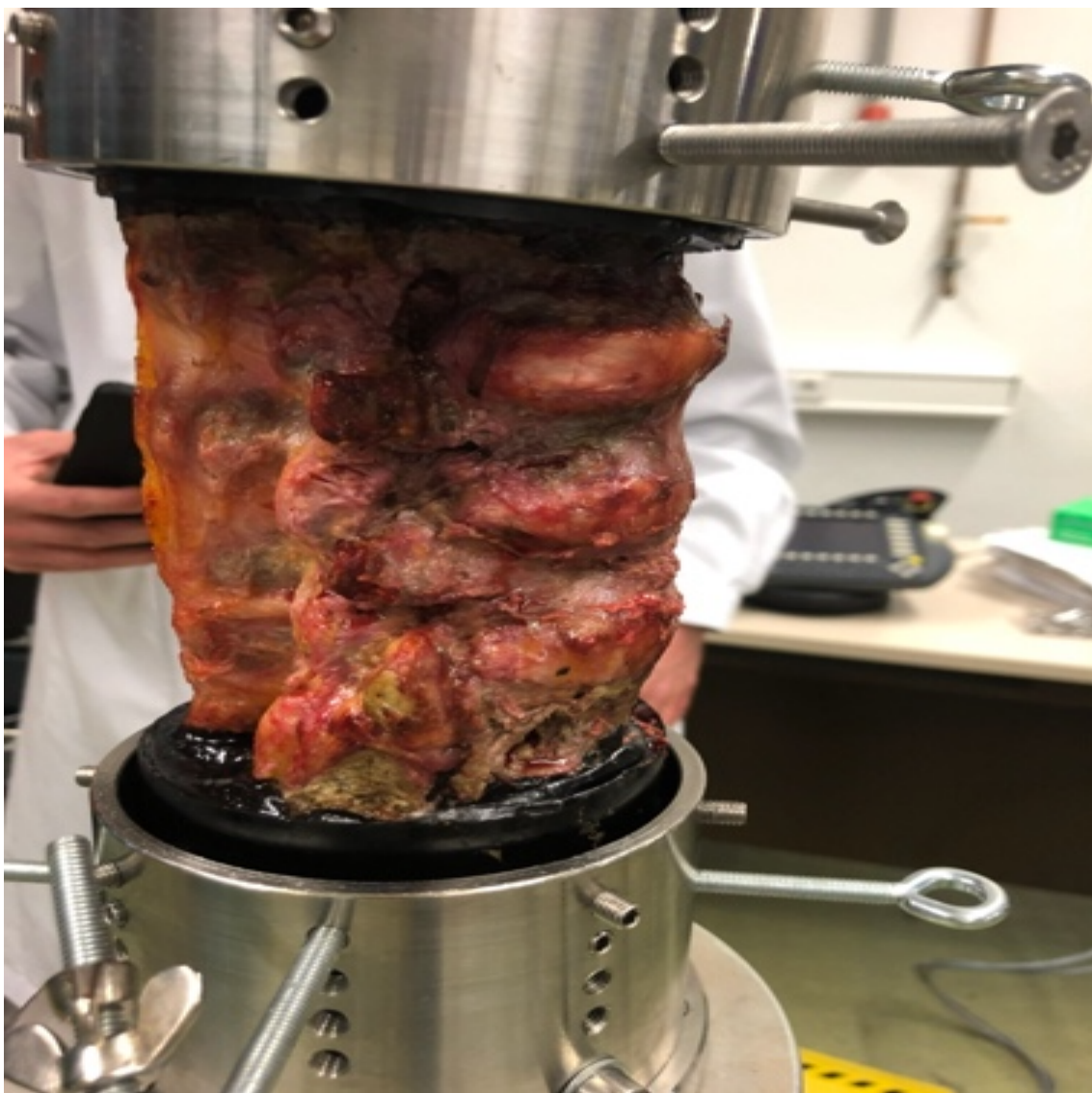
Abbildung 4: Eingespannte Wirbelsäule im KUKA-Roboter
