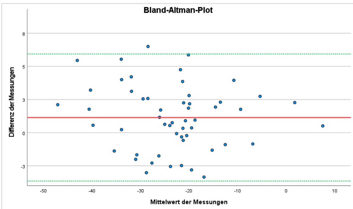
Abbildung 10: Darstellung eines Bland-Altman-Plots in dem der Mittelwert der Messungen (x-Achse) gegen die Differenz der Messung (y-Achse) aufgetragen wird. Die rote Linie entspricht dem Mittelwert der Differenz. Die grün gepunkteten Linien den LOAs (Limits of Agreement). (eigene Abbildung)
