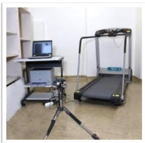
Abbildung 7: Laufband mit Druckmessplatte (rechts), Auswertungseinheit (links) und Kamera (vorne)
