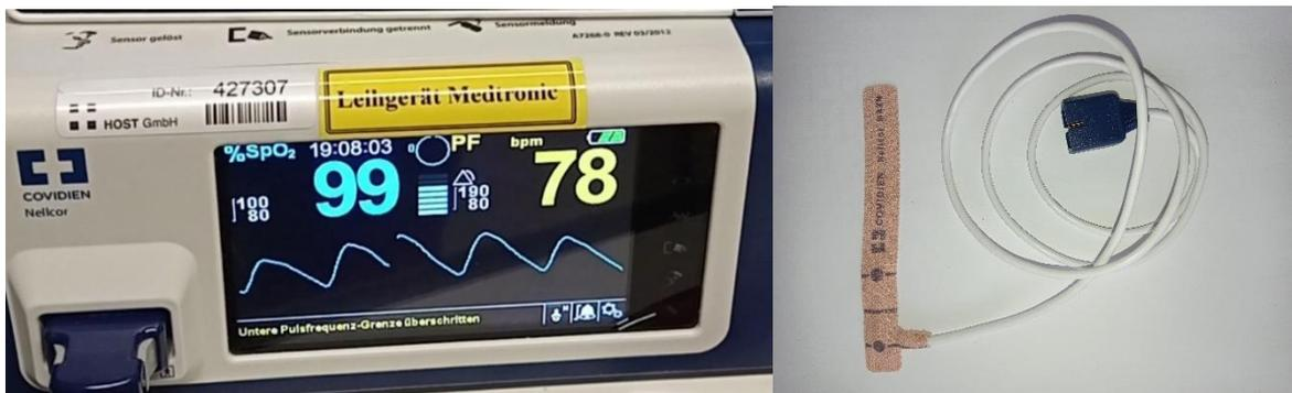
Abb. 7 Nellcor Oximax Messsystem mit dem Sensor
