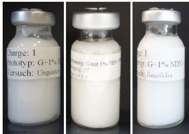
Abb. 65: Makroskopische Aufnahme der wirkstoffhaltigen Proben der finalen Formulierung (Charge 1) hergestellt in gako unguator PRO mit 50 g (links) und 200 g (mitte) und BECOMIX RW 2,5 (rechts) mit 2000 g
