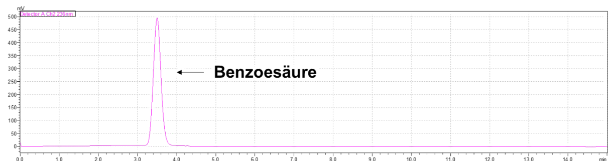
Abb. 9: Referenz-Chromatogramm von Benzoesäure in ACN im Rahmen der Methodenentwicklung
