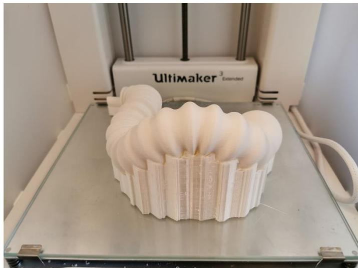
*Abbildung 4: Gedruckte Duodenalform mit Stützelement im 3D-Drucker. Bauraumgröße (B x H x T) 21,5 cm x 21,5 cm x 30 cm.*
