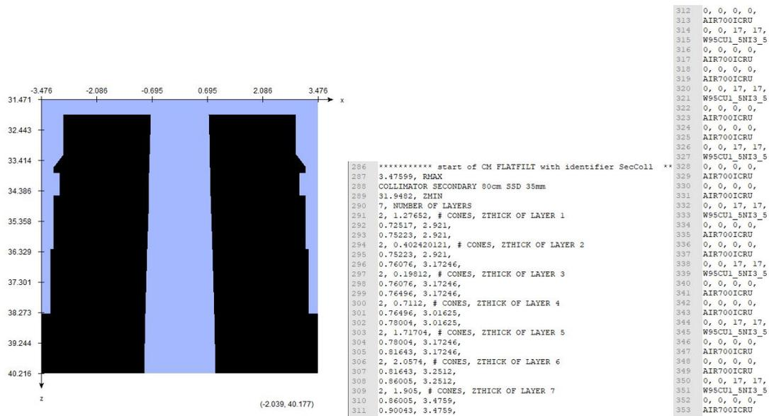
Abbildung A.15: BEAMnrc Input Datei Sekundärkollimator mit 35 mm Durchmesser (Fix)
