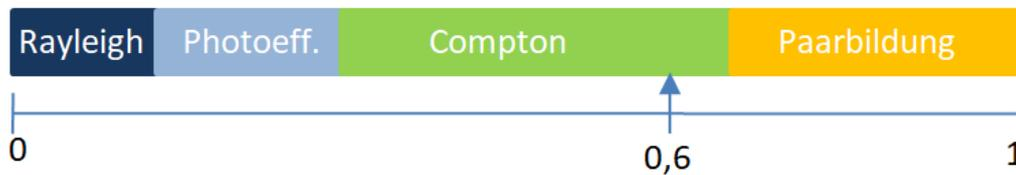
**Abbildung 2.6:** Bestimmung des Interaktionsereignisses eines Photons in Abhängigkeit der generierten Zufallszahl. In diesem Fall ist die Zufallszahl 0,6. Dies fällt in das Intervall des Comptoneffekts. Die Intervalllänge ergibt sich aus dem Wirkungsquerschnitt bezogen auf die Summe aller Wirkungsquerschnitte.
