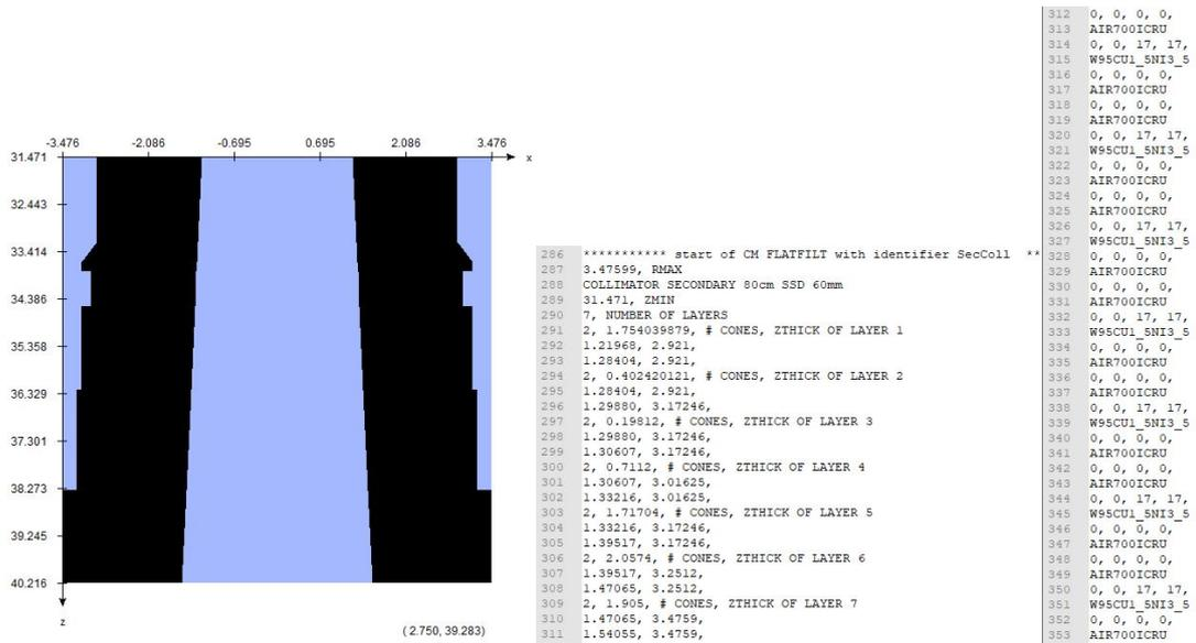
Abbildung A.12: BEAMnrc Input Datei Sekundärkollimator mit 60 mm Durchmesser (Fix)
