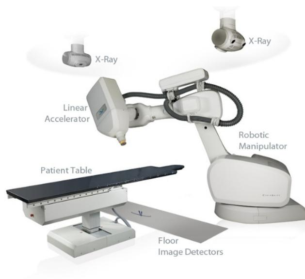
**Abbildung 2.8:** Cyberknife<sup>©</sup> VSI System: 6-Achsen-Roboter mit Linearbeschleuniger, Patiententisch, Röntgenbildgebung mit 2 Röntgenröhren, welche an der Decke befestigt werden und Detektoren, welche im Boden eingelassen sind [1].
