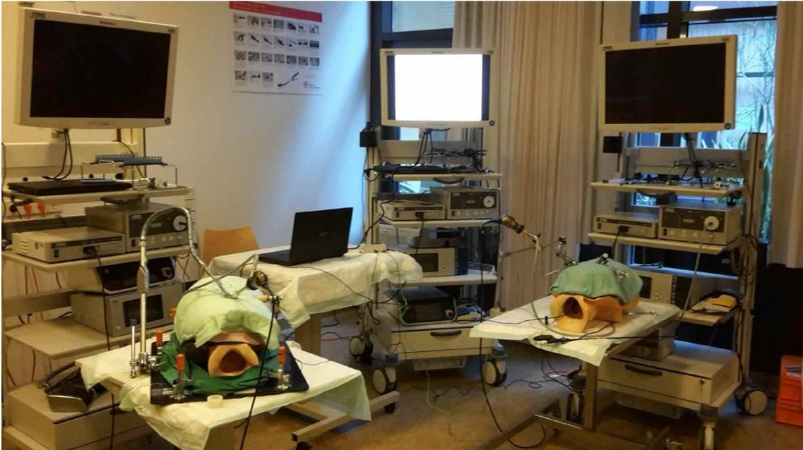
**Abbildung 10: Versuchsaufbau (von rechts): Übungsaufgabe, Bildschirm für Anweisungen, Messstation der Versuchsleiterin, Messphantom**
